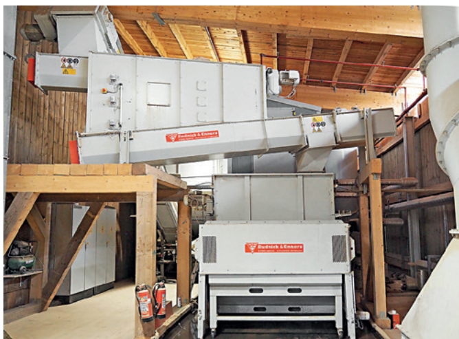
Vor zwei Jahren hinzugekommen: der zweite Bandrockner von Rudnick & Enners inklusive einer Wärmerückgewinnung
