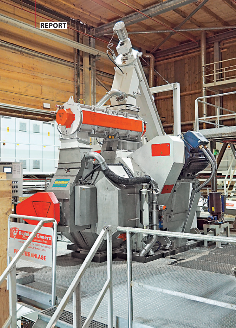
Seit November 2023 ist die neue Pelletspresse des Typs PM7 von Rudnick & Enners im Sägewerk Holtmeyer in Betrieb
