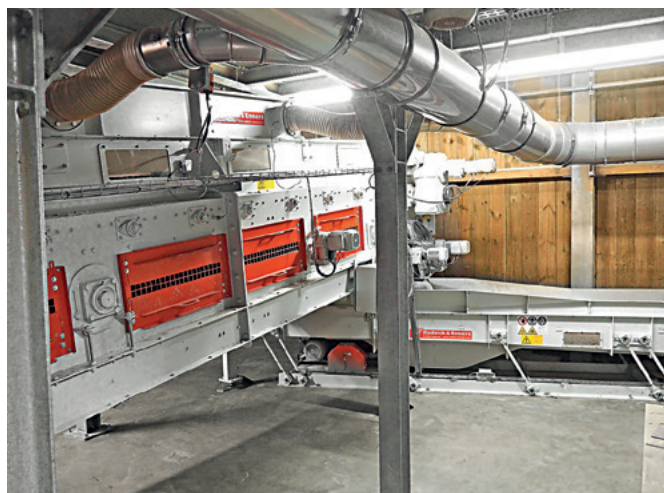
Im Horizontalkühler von Rudnick & Enners haben die Pellets Zeit abzukühlen. Danach geht es rechts in die Siebrinne, um den Staub herauszufiltern
