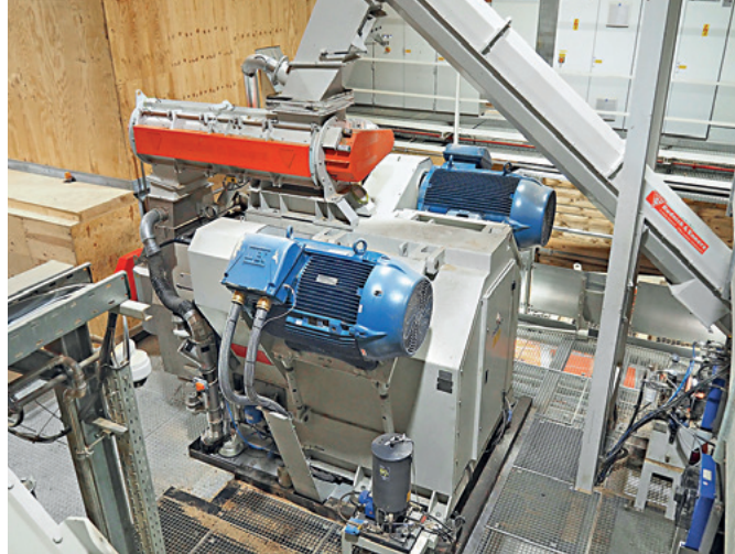
Zwei jeweils 280 kW starke Motoren sorgen bei der PM7-Presse für eine Leistung von 7 bis 8 t/h
